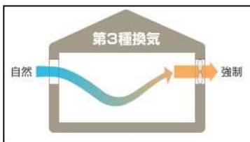
第3種機械換気とは、換気機器で強制的に室内側の空気を室外へ排出して、壁面などに取り付けられた換気口から差圧を利用して室内に外気を取り入れる換気方法です。
